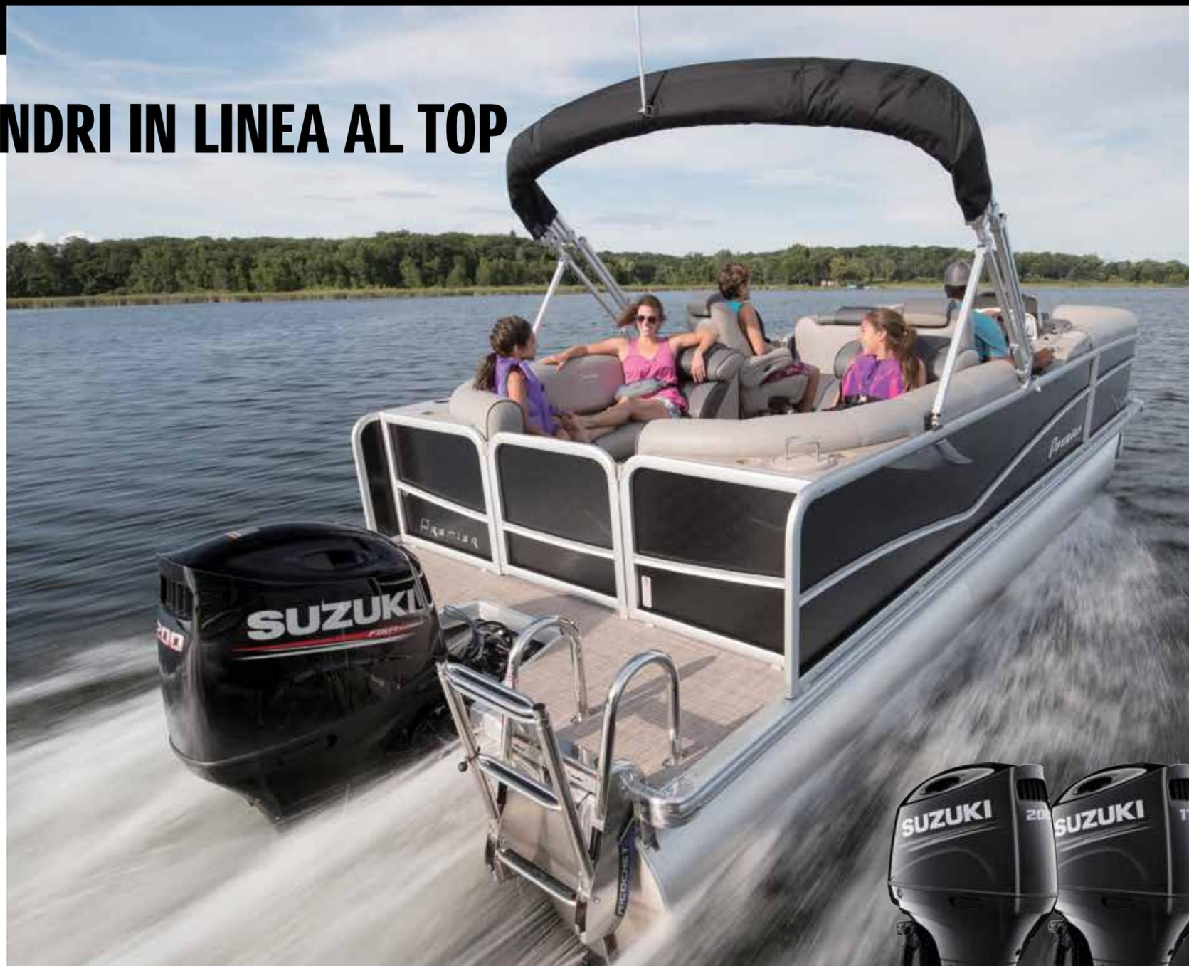
Pur con un'importante riduzione dei pesi e con "soli" 4 cilindri, il propulsore "BIG BLOCK" da 2.867cm<sup>3</sup> può erogare la stessa potenza della versione V6. In aggiunta, la qualità del progetto si esprime anche grazie all'adozione delle collaudate tecnologie "Suzuki Selective Rotation" e "Suzuki Precision Control", già applicate sul DF200AP di pari cubatura. Tutto ciò per una guida confortevole e precisa in ogni condizione.
